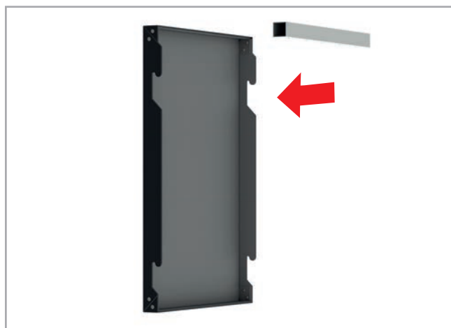
2. Perforación del tubo de 30 x 30 x 1,4 mm con \varnothing 6 mm, y situación en la nueva bandeja.
