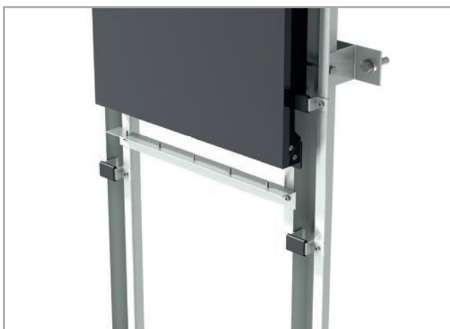
3. Colocación de tornillos 4,2 x 13 DIN 7504 N inox en perfil "L" de 30 x 20 x 1,3 mm, y fijación de éste al perfil OMEGA.
